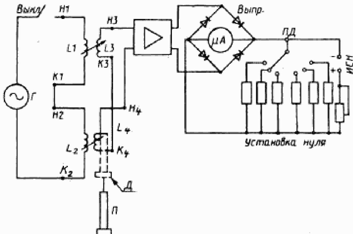
$G$  — генератор;  $L_1$  и  $L_2$  — катушки индуктивности первичные;  $L_2$  и  $L_4$  — катушки индуктивности вторичные;  $H_1, H_2, H_3, H_4$  — начало обмоток;  $K_1, K_2, K_3, K_4$  — концы обмоток;  $Выпр.$  — выпрямитель;  $\mu A$  — микроамперметр;  $ПД$  — переключатель диапазонов;  $Установка нуля$  — переменное сопротивление установки нуля;  $ИСН$  — источник стабилизированного напряжения;  $Д$  — датчик;  $У$  — усилитель;  $Выкл.$  — выключатель
